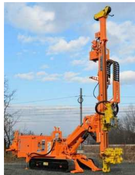
Réalisation de micropieux pour renforcer les culées côté place de la Liberté
